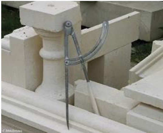
Compas droit avec secteur, un bricolage maison effectué par Erick Mettavant sur l'une des branches, nous révèle un crayon de bois scotché, pour d'éventuels tracés.
